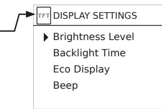
Um das Menü ANZEIGE zu öffnen, halten Sie CONFIG gedrückt, bis das Menü erscheint, wählen Sie EINSTELLUNGEN und drücken Sie OK, wählen Sie schließlich ANZEIGE und drücken Sie OK. Um die Helligkeit des Bildschirms einzustellen, wählen Sie Helligkeitsstufe und drücken Sie OK. Die EIN-Stufen liegen zwischen 1=25%, 2=50%, 3=75% und 4=100%.
