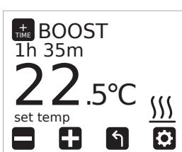
Um die BOOST-Temperatur einzustellen, verwenden Sie die Tasten +/- . Um die Dauer einzustellen, drücken Sie die Taste CONFIG, der Bildschirm zur Einstellung der BOOST-Zeit wird angezeigt; stellen Sie die gewünschte Zeit zwischen 1 Stunde und 24 Stunden ein. Um zum BOOST-Bildschirm zurückzukehren,
