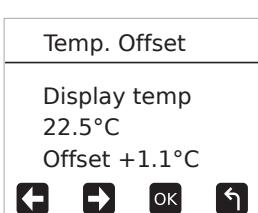
Mit dem Temperatur-Offset-Menü kann die angezeigte Temperatur um  $\pm 3^{\circ}\text{C}$  angepasst werden. Die Einstellung dieses Sollwerts wirkt sich auf den Betrieb der Thermostat-Sollwerte aus; eine Änderung dieser Einstellung wird nur empfohlen, wenn die angezeigte Temperatur merklich von der eines anderen Sensors im Raum abweicht.
