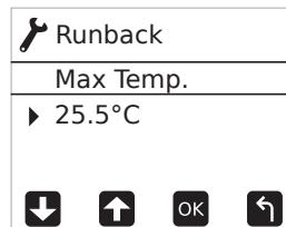
Mit der Einstellung Max. Temperatur kann der Installateur eine höhere Temperatur als den Runback-Temperatursollwert einstellen, um dem Benutzer einen gewissen Spielraum bei der Raumtemperatur zu geben. Normalerweise wird diese Einstellung 1-2°C höher als die Runback-Einstellung gewählt.
