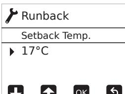
Diese Temperatur kann zwischen 7°C (Minimum) und 0,5°C weniger als der Rücklauftemperatursollwert eingestellt werden. Wenn die Absenkung in Betrieb ist, wird auf dem Bildschirm "Absenkung" und der Sollwert angezeigt.
