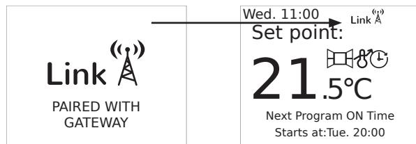
AUTO, MANUELL) befindet. Nach Abschluss des Pairing-Vorgangs wird auf dem Display "Link" mit einer Antenne angezeigt und anschließend die gleichen Informationen in der oberen rechten Ecke des Bildschirms. Der Handtuchhalter ist nun bereit, Programmanweisungen vom Gateway/von der App anzunehmen. Für die Nutzung der App ist ein SmartControl-Konto erforderlich, schließen Sie den Aktivierungsprozess ab, unter:
