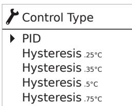
Das Menü Steuerungstyp ermöglicht zwei Arten der Steuerung der Temperaturregelung. PID berechnet den besten Schaltpunkt für die Heizung in Abhängigkeit von den vorherigen Raummesswerten.
