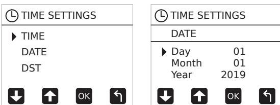
CONFIG, um das Menü zu verlassen. Um das Datum einzustellen, wählen Sie das Menü Datum, drücken Sie OK und geben Sie den Tag, den Monat und das Jahr ein. Um das Datumsmenü zu verlassen, drücken Sie die Taste CONFIG. Der Handtuchhalter kann die Zeitverschiebung für die Sommerzeit automatisch anpassen. Um diese
