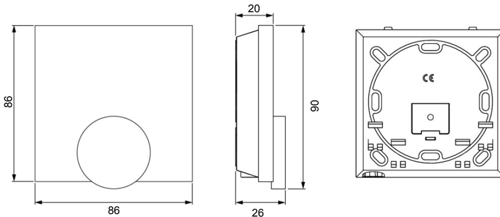
Abb. 1: Abmessungen OEM Alpha 2: Raumbediengerät Bus Analog (Angaben in mm)
